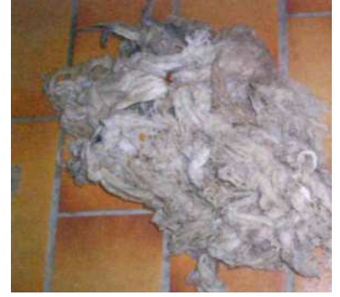
„Verzopfungen“ – ein sehr großes Ärgernis im Klärwerksbetrieb
