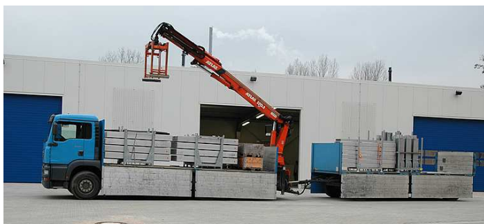
Abb. 85: Aufladen der mobilen Elemente vor der Lagerhalle (HWS Miltenberg) [www.wwa-ab.bayern.de]
