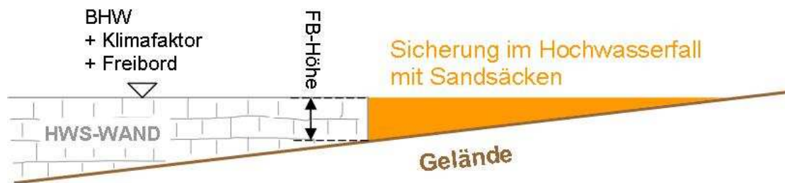
Abb. 87: Sicherung des auslaufenden Freibordes mit Sandsäcken
